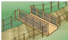
Figura 5 – Passarela em escavação para circulação de pessoas
