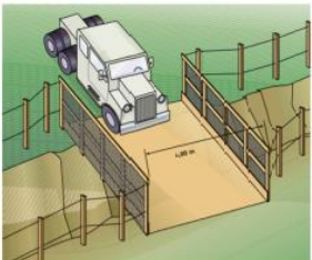
Figura 6 – Passarela para o tráfego de veículos sobre escavação
