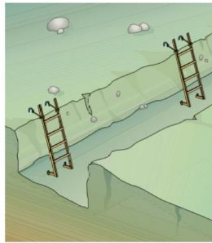
Figura 2 – Instalação de escadas em escavação de vala com mais de 1,25 m de altura
